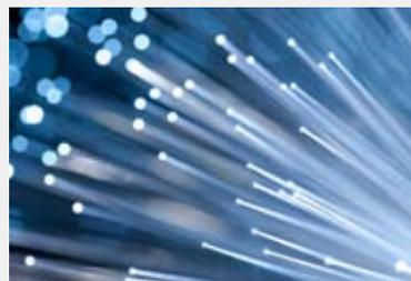
wird zur optischen Datenübertragung verwendet. Gegenüber traditioneller Übertragung via Kupferkabel bietet sie eine wesentlich höhere maximale Bandbreite. Glasfaser ist zudem unempfindlich gegenüber elektrischen und magnetischen Störfeldern und bietet eine höhere Abhörsicherheit.
